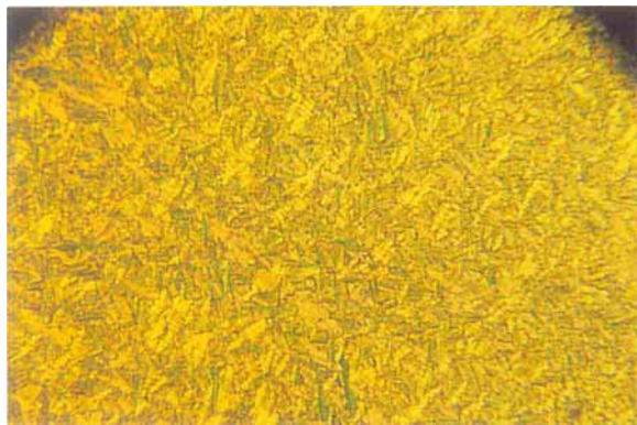
Abb. 1. Mikrophotographie des \text{CuL}_2 -Komplexes in seiner chiralen smektischen C-Phase bei 115 °C, durch gekreuzte Polarisatoren betrachtet; 1 cm \approx 200 \mu\text{m} .
